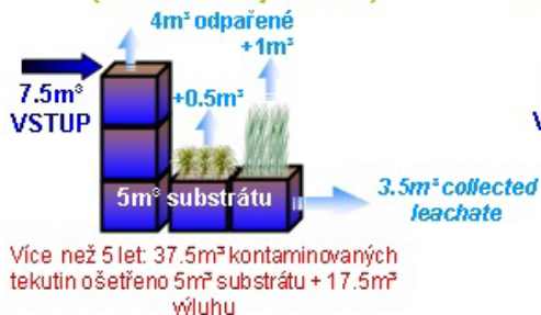
Obr. 37: Příklady pro zvážení dimenzování biočisticího systému
