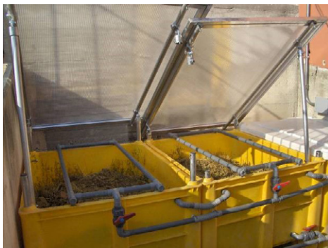
Obr. 25 a 25: Jako alternativu k betonu lze biobed ohraničit také plasty, jako např. EPDM (vlevo, zdroj ADAS) a PE kontejnery (vpravo, zdroj Mybatec).
