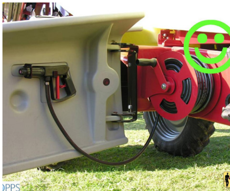
Obr. 6 a 7: Postřikovač na mycí rampě před očištěnou, vybavení postřikovače pro vnější očištění (Foto: TOPPS, Petr Harašta)
