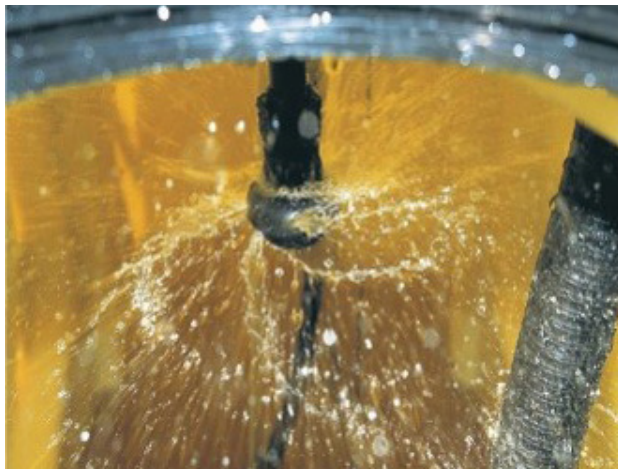
Obr. 9: Rotační tryska v nádrži při výplachu
