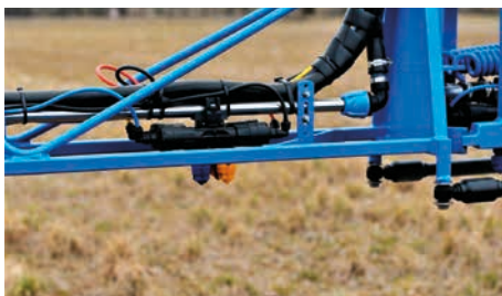
Pro různé POR se používají různé trysky, dnes už většinou tzv. nízkouletové
