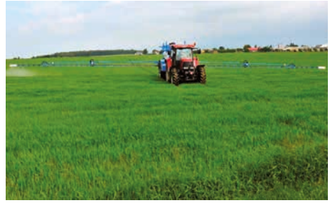
Přesná aplikace POR – nad místy, kde se škodlivý organismus nevyskytuje, jsou trysky vypnuté
