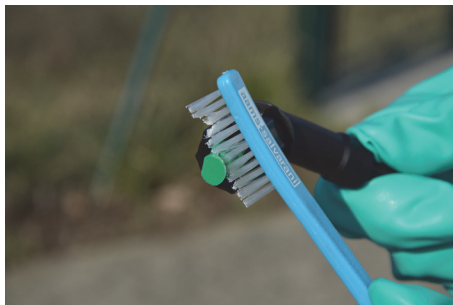
Znečištěné nebo ucpané trysky se čistí pomocí kartáčků
