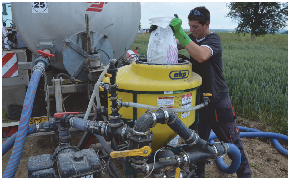
Rozmíchání přípravku v míchárně postřikové kapaliny - obsluha bez vhodných osobních ochranných prostředků
