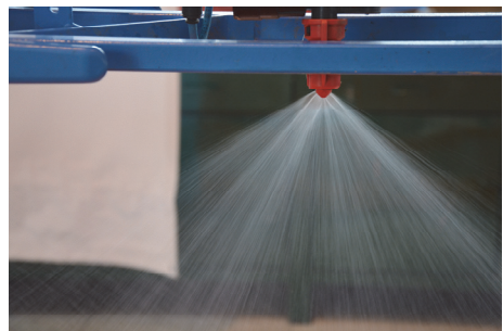
Správný výstřikový obrazec dvouštěrbínové trysky
