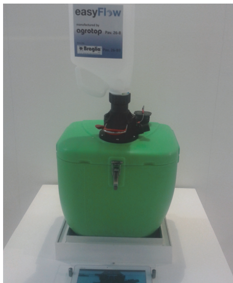
Systémy bezkontaktního plnění přípravků na ochranu rostlin do nádrže postřikovače
