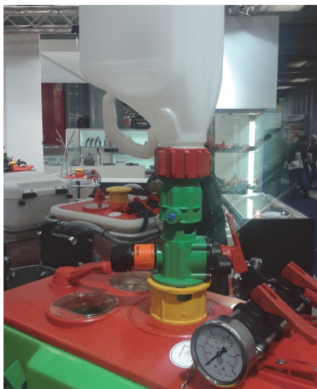
Systémy bezkontaktního plnění přípravků na ochranu rostlin do nádrže postřikovače
