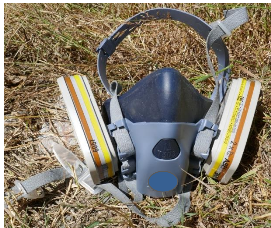
Polomaska (podle ČSN EN 140) s připojenými filtry
