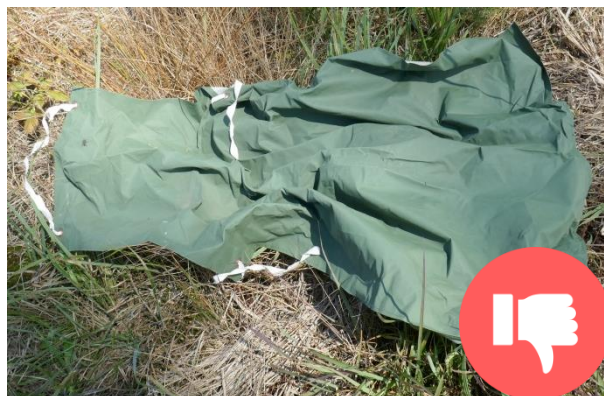
polyetylenové necertifikována, nezaručuje ochranu proti chemikáliím
