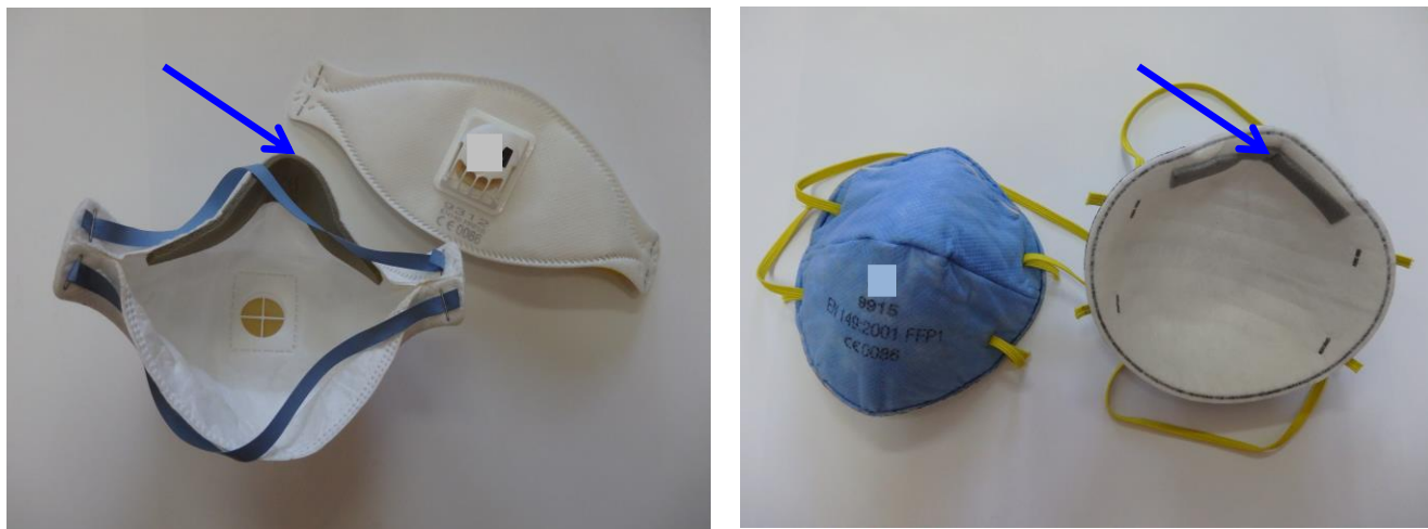
Obr.: Vlevo - filtrační polomasky s vdechovacím ventilem skládací (praktičtější při používání) Vpravo - filtrační polomasky mušlovitého typu bez ventilku (na obrázku jen typu FFP1) důležité (šipka) – kolem nosu vždy utěsnit/přimáčknot, pásy utáhnout
