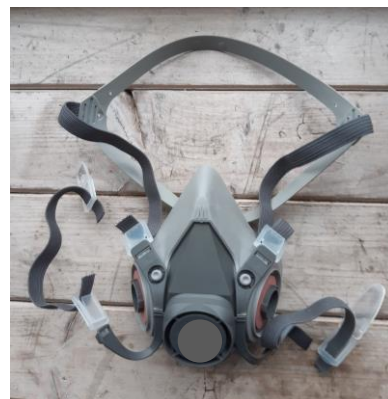
Obr.: Polomaska (podle ČSN EN 140) – zde na foto je ale bez připojených filtrů
