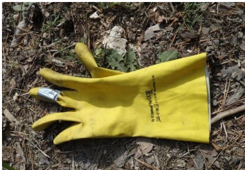
poškozené/protržené zalepené izolepou nepoužívat a zlikvidovat
